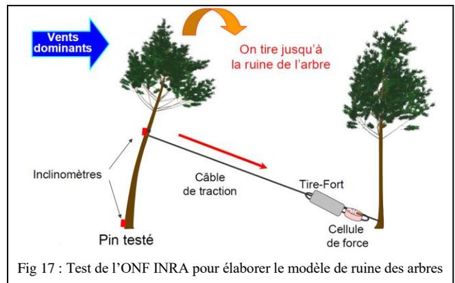
Fig 17 : Test de l'ONF INRA pour élaborer le modèle de ruine des arbres
