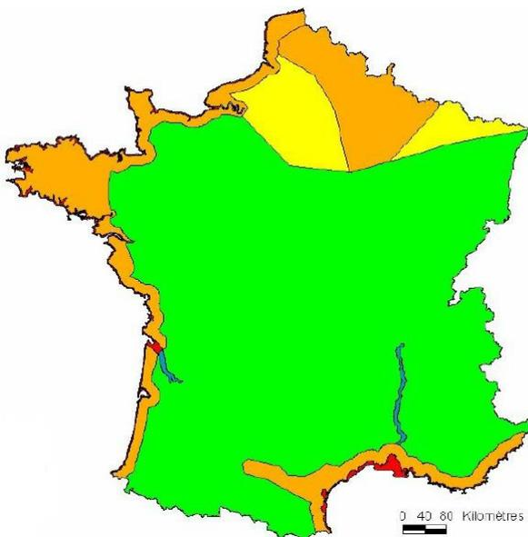
Fig 5 : Exemple de zones de vent en France utilisées pour le dimensionnement des ouvrages HTB aériens
