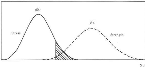
Figure 14 : Modèle de fiabilité contrainte (stress) résistance (Strength)
