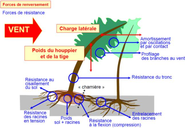
Figure 13 : Représentation des contraintes mécanique sur un arbre [3]
