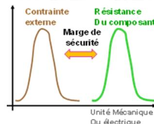
Fig 1 : modèle de fiabilité Contrainte Résistance
