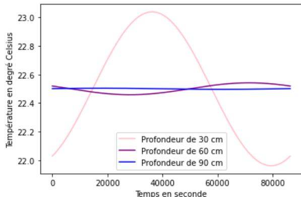
Fig 44 : Exemple de calcul théorique de la température à différentes profondeurs -30 cm, -60 cm, -90 cm.
