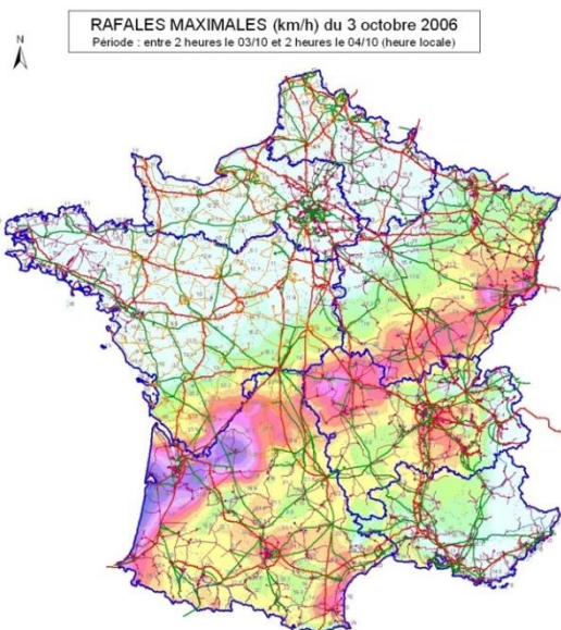
Figure 10 : Carte de vent de MétéoFrance projetée sur le réseau de RTE (lignes rouges 400 kV et vertes 225 kV) pour la Tempête RENATE (2006)
