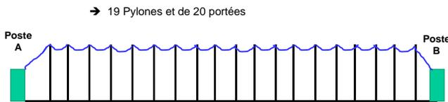
Figure 32 : Ligne HTB avec 19 pylônes et 20 portées
