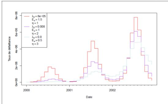
Fig. 40 : exemple de modélisation de l'augmentation de pannes par mois l'été avec le modèle de fiabilité de Peck [9]
