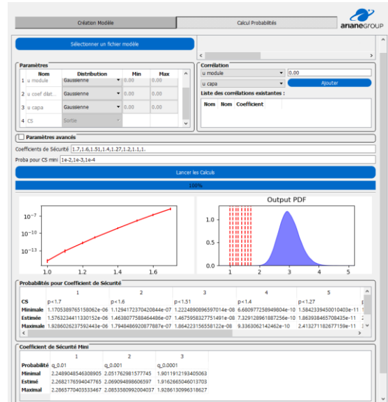
Fig. 11 Visualisation de l'outil interne ArianeGroup pour le calcul de la probabilité de défaillance
