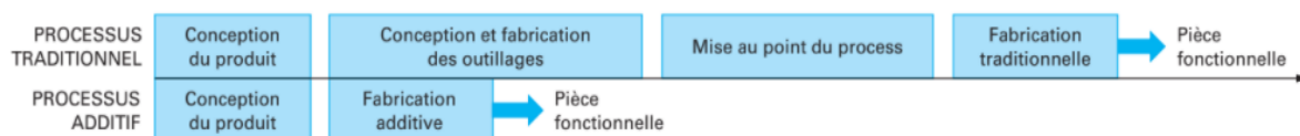
Figure 6 - comparaison des processus de fabrication : impact sur les temps et les étapes de développement [BM7017]
