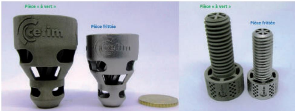
Figure 12 - Pièces obtenues par projection de liant (binder jetting), comparaison avant / après frittage (source. CETIM) [17]
