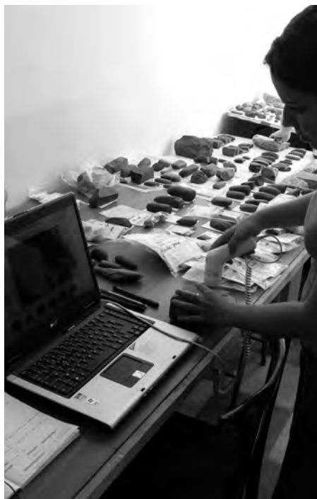
Fig. 19 — Enregistrement de l'état de surface des lames en pierre polie à l'aide du proscope.
