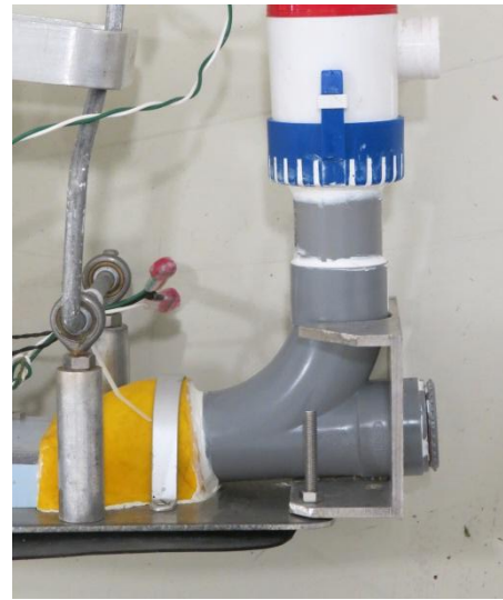
Figure 3 : Pompe et son positionnement à la verticale
