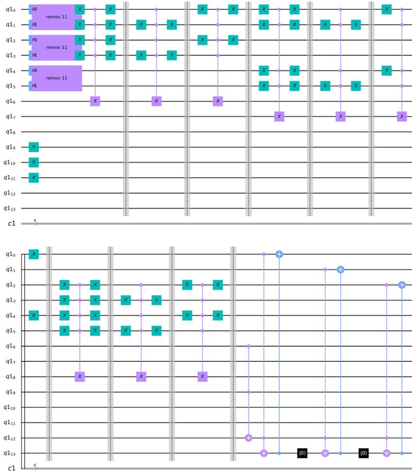
Figure 6.3.3: Méthode Q. Circuit pour le graphe triangulaire et trois couleurs (1/3).
