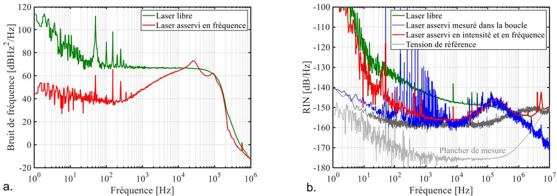
Figure 2 : a. Bruit de fréquence du laser quand l'émission est asservie sur une transition optique du césium.
