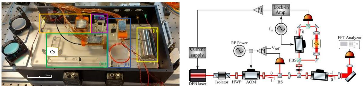
Figure 1 : Banc miniature et schéma d'asservissement et de mise en forme du laser pour l'interrogation atomique.
