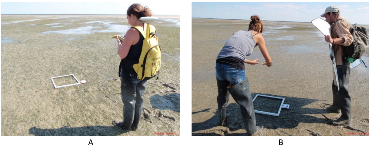
Figure 10 : Illustrations du positionnement par DGPS Trimble GeoXT (A) et de la prise de photo d'un quadrat avec utilisation d'un pare-soleil (B). Crédit photo C. Curty et P. Cajeri CNRS ©.
