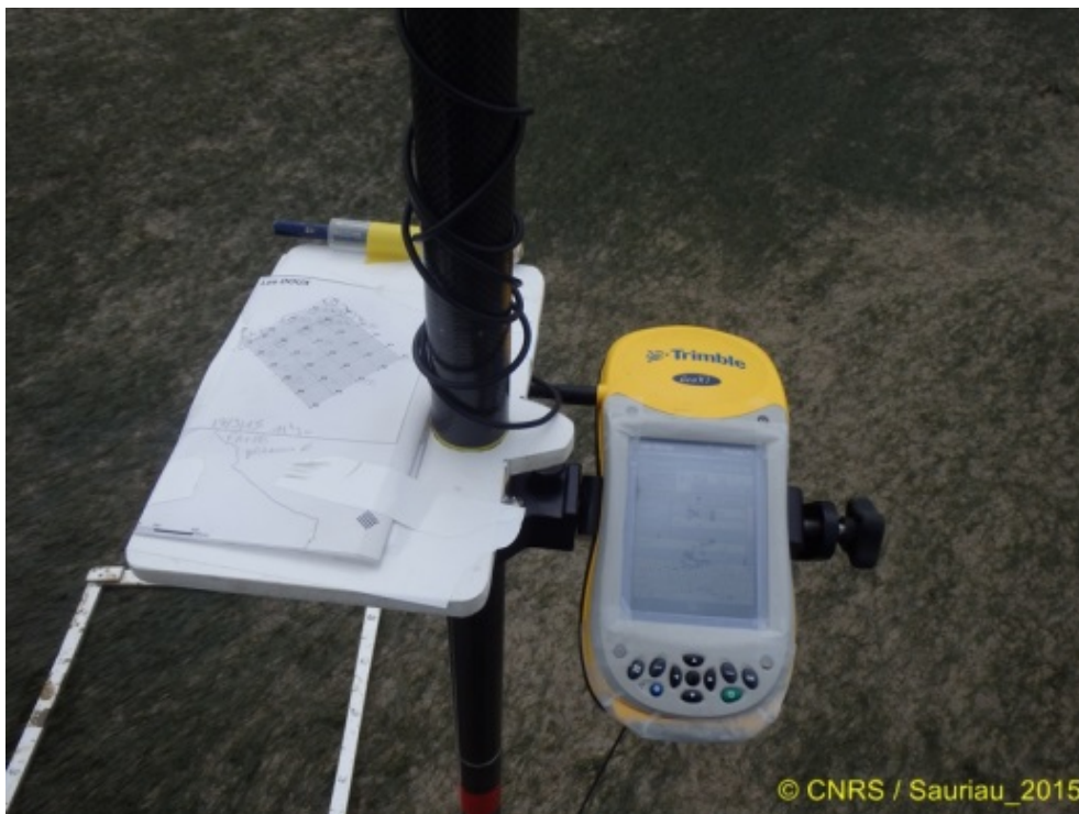
Figure 11 : Illustrations du DGPS Trimble GeoXT et de la prise de notes manuelles sur la grille Les Doux en septembre 2015. Crédit photo Sauriau P.-G. CNRS ©.
