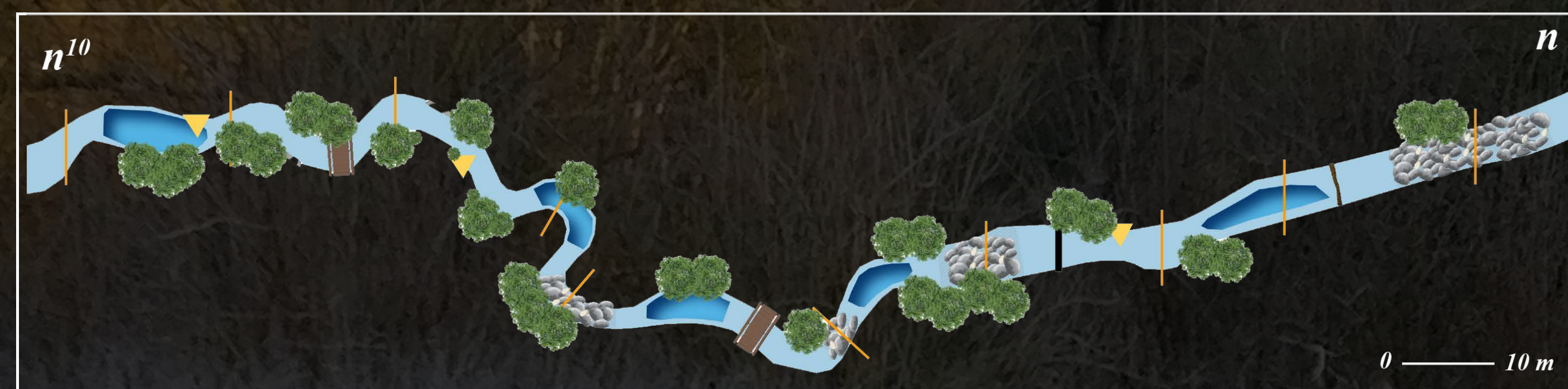
n 10 n 0 10 m — Transects Rejets (urbains, agricoles, privés) Protections de berge (enrochement, muret, fascine...) Radiers Mouilles Embâcles Seuils Ouvrages transversaux (ponts, passerelles, routes...)
