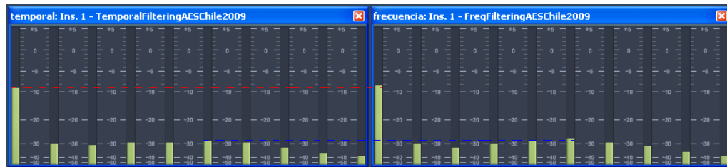
Figura 3.8: Valores RMS en los plug-ins VST programados. El cálculo en el dominio de la frecuencia (derecha) muestra una tendencia a presentar valores RMS mayores que la implementación temporal (izquierda), tal como ocurre en su versión off-line programada en MATLAB® (Figura 3.7).
