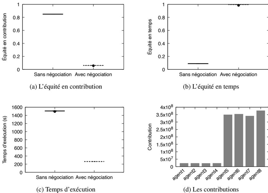
FIGURE 6.5 – Les métriques médianes et écarts types représentés par des diagrammes en boîtes (a,b,c), et les contributions après négociation dans une exécution du *job* RecByTempSta dans un environnement hétérogène (d).
