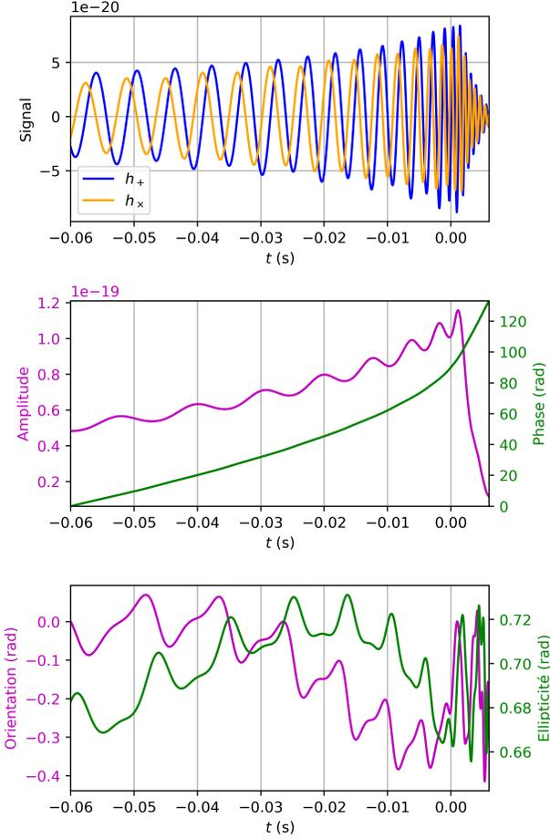
FIGURE 2 – Formes d’ondes et paramètres pour une binaire (telle que  $q = 4.6$  et  $|\chi_1| = 0.94$ ,  $|\chi_2| = 0.64$ ) avec une inclinaison  $\iota = \pi/3$  et animée d’une faible précession orbitale. Haut : parties réelle (bleu) et imaginaire (orange) de la forme d’onde  $h(t)$ . Milieu : amplitude (violet) et phase (vert) de  $h(t)$ . Bas : orientation (violet) et ellipticité (vert) de  $h(t)$ .
