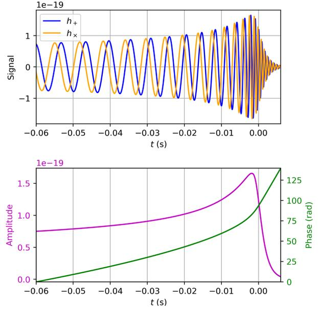
FIGURE 1 – Forme d'onde obtenue dans le cas d'une fusion de binaire sans précession (avec un ratio des masses  $q = 3.3$  et des spins sans dimension  $|\chi_1| = 0.91$ ,  $|\chi_2| = 0.76$ ) vue de face (inclinaison  $\iota = 0$ ). Haut : partie réelle (bleu) et imaginaire (orange) de la forme d'onde  $h(t)$ . Bas : module (violet) et phase (vert) de  $h(t)$ .
