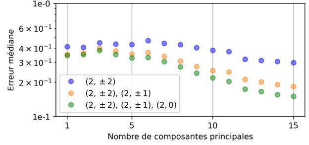
FIGURE 3 – Erreur de reconstruction due à la troncature de l’ACP appliquée à chaque attribut des différents modes. Bleu : seulement le mode  $(2, \pm 2)$  est utilisé pour l’approximation de  $h(t)$ . Orange : les modes  $(2, \pm 2)$  et  $(2, \pm 1)$  sont utilisés pour l’approximation de  $h(t)$ . Vert : les modes  $(2, \pm 2)$ ,  $(2, \pm 1)$  et  $(2, 0)$  sont utilisés pour l’approximation de  $h(t)$ .
