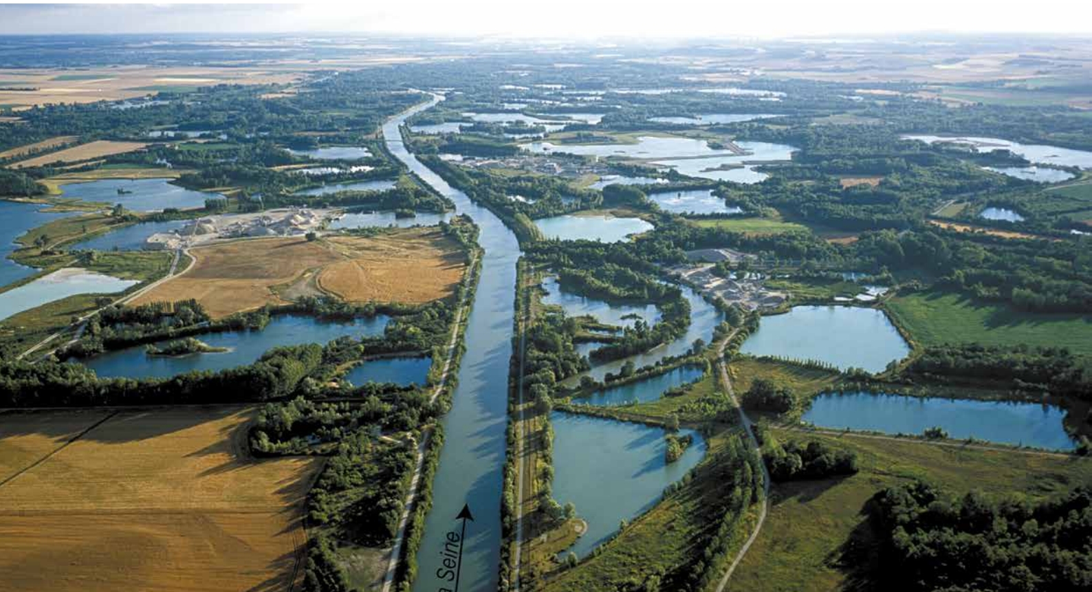
Figure 31. La Seine rectifiée entre Bray-sur-Seine et Montereau-Fault-Yonne. Dans la plaine alluviale, les plans d'eau de formes géométriques correspondent aux zones d'extractions de granulats. La plupart de ces gravières datent de la seconde moitié du XX e siècle et certaines sont encore en activité aujourd'hui. (Crédits photo : Pérouse, 2005).
