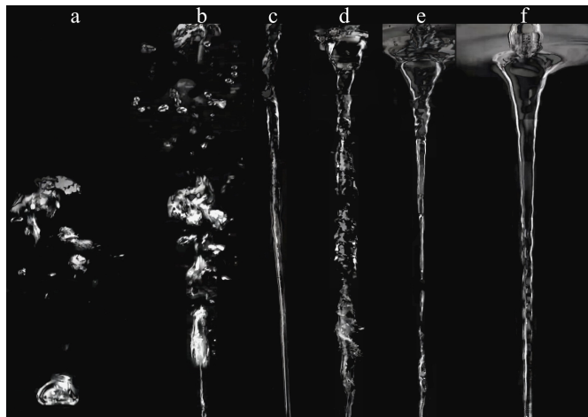
Figure 1. Photographies successives pour \Omega = 9 rpm. a) Régime de bulles. b) Transition entre le régime de bulles et le régime de jet d'air tourbillonnant. c) Régime de jet d'air tourbillonnant établi. d) et e) Transition entre le régime de jet et le régime de vidange tourbillonnaire. f) Régime de vidange tourbillonnaire établi.
