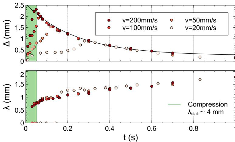
**Figure 1.** Évolution de la distance de compression d'une feuille mince de PDMS de 50  $\mu\text{m}$  d'épaisseur sur une huile silicone de 30 Pa  $\cdot$  s ainsi que la longueur d'onde au cours du temps.
