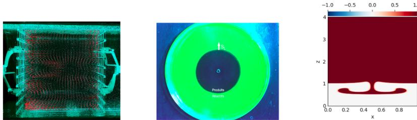
**Figure 1.** (a) Système de grilles oscillantes dans une cuve d'eau ; (b) Photographie instantanée de la propagation de la réaction chimique autocatalytique dans un milieu au repos observée par LIF ; (c) Simulation numérique de l'évolution du champ de concentration avec  $C = 0$  correspondant au produit et  $C = 1$  au réactif.
