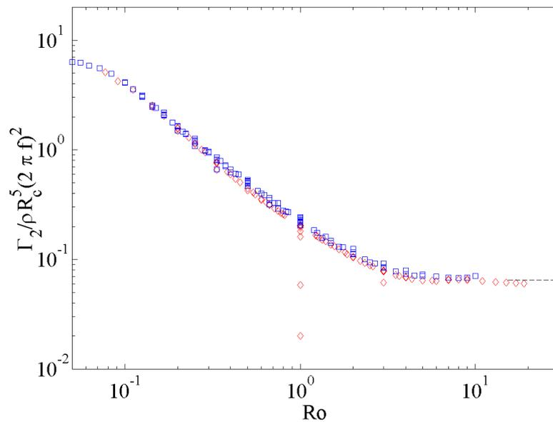
**Figure 1.** Couples adimensionnés fournis par l'un des moteurs en fonction du nombre de Rossby de l'écoulement de von Kármán dans le cas de l'écoulement usuel (symbole rouges) et de l'écoulement mis en rotation d'ensemble (symboles bleus).
