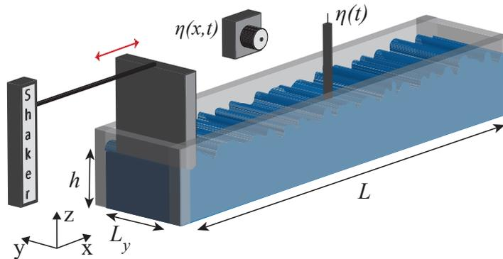
**Figure 1.** Dispositif expérimental : forçage par batteur, et mesure du champ d'ondes par une sonde localisée,  $\eta(t)$ , et par une caméra latérale visualisant l'interface  $\eta(x,t)$  [2]. Cambrure typique des vagues  $\epsilon \sim 0,05$ .
