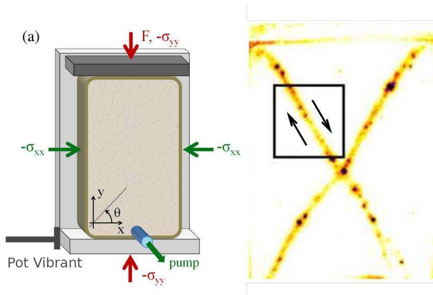
**Figure 1.** À gauche : principe du test biaxial. À droite : bandes de cisaillement après la localisation en l'absence de vibrations.
