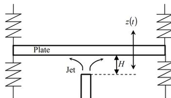
Figure 1. Schéma du montage expérimental. Crédits : [1].
