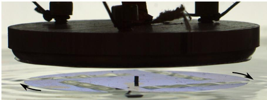
**Figure 1.** Le moteur est un disque de plastique percé de 4 fentes dans lesquelles sont excitées paramétriquement des ondes grâce à une électrode circulaire. Ces ondes devenues propagatives en sortant des fentes permettent la mise en rotation du disque par pression de radiation.
