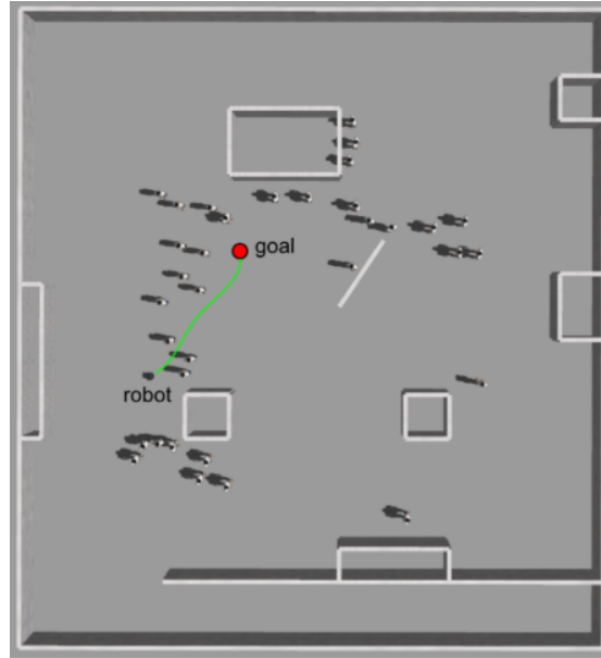
Fig. 4: Exemple de scénario dans le simulateur Gazebo. Le trajet emprunté par le robot est représenté en vert.
