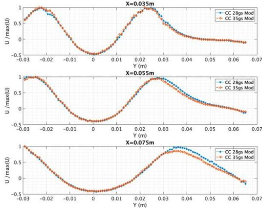
Figure 8 : Profils de vitesse axiale adimensionnée par la vitesse maximale pour 28g/s et 35g/s modulé pris à 3.5, 5.5 et 7.5 cm
