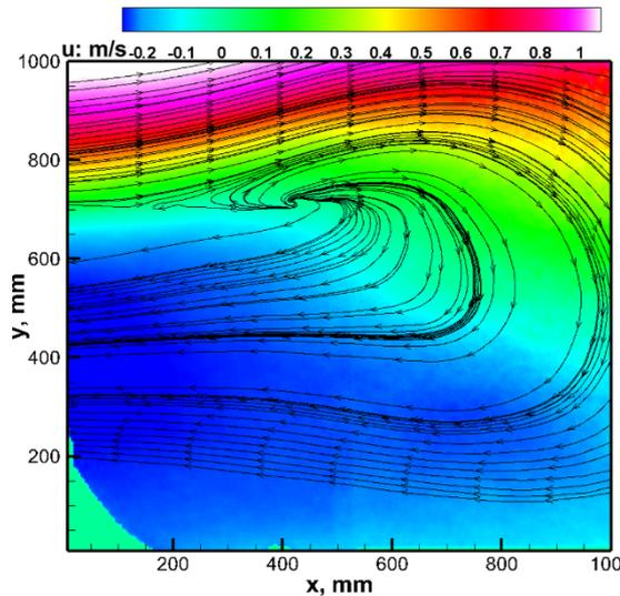
Figure 6 : Champ PIV moyen, puissance 300kW
