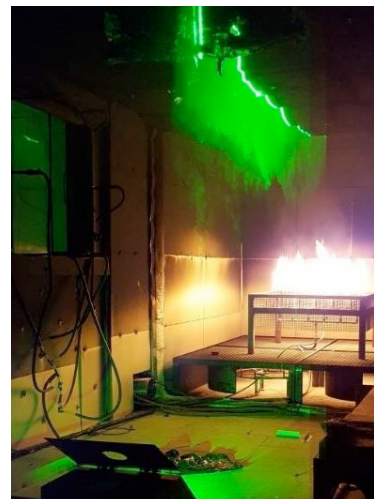
Figure 3 : Représentation du faisceau laser (a) et photo de la nappe en condition réelle (b).
