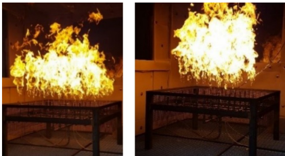
Figure 2 : Matrice de 36 brûleurs et images de flamme pour deux puissances -minimum et maximum dans une configuration dite « ventilée » et une autre « confinée » pour différentes puissances de feu.
