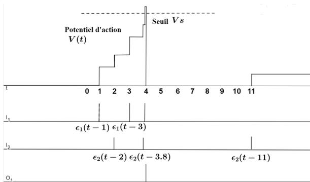
Figure 2: Schéma simplifié de l'évolution du potentiel d'action  $V(t)$  et de la sortie  $O_1$  du neurone en fonction des impulsions arrivant sur les entrées  $I_1$  et  $I_2$
