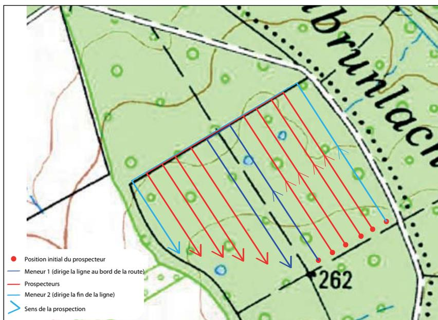
Fig. 18 : Schéma illustrant la méthode de prospection en ligne
