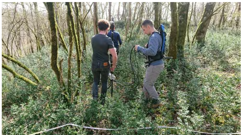
Figure 107: Photographie de prospection, vue de la configuration nécessaire au levé de données magnétiques.
