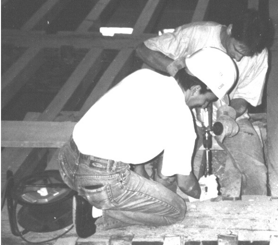
Photo 1 (Lavier) : Prélèvement à la tarière électrique
