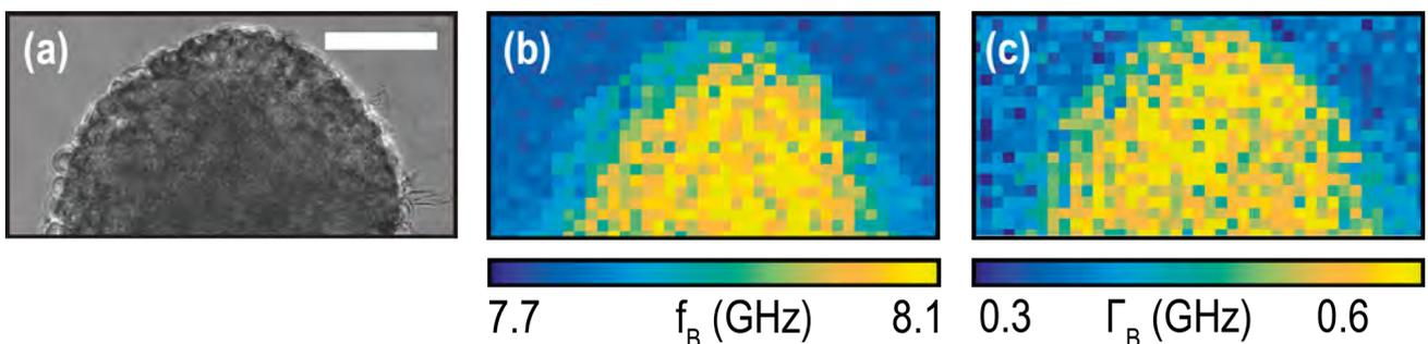
Au cours des 10 dernières années, la spectroscopie Brillouin dans les matériaux biologiques a pris également une place importante. Il est en effet possible d'extraire de ces mesures la rigidité (position du pic) et la viscosité (largeur du pic) et de suivre l'évolution des propriétés mécaniques d'un milieu biologique en fonction de stimuli externes ou lors de la croissance cellulaire.
