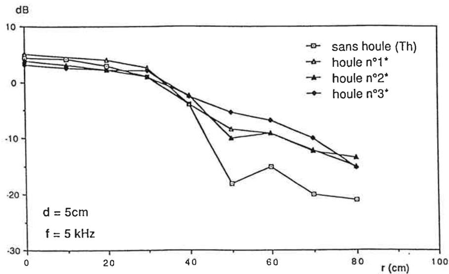
Figure 6 Atténuation du niveau de pression transmise
