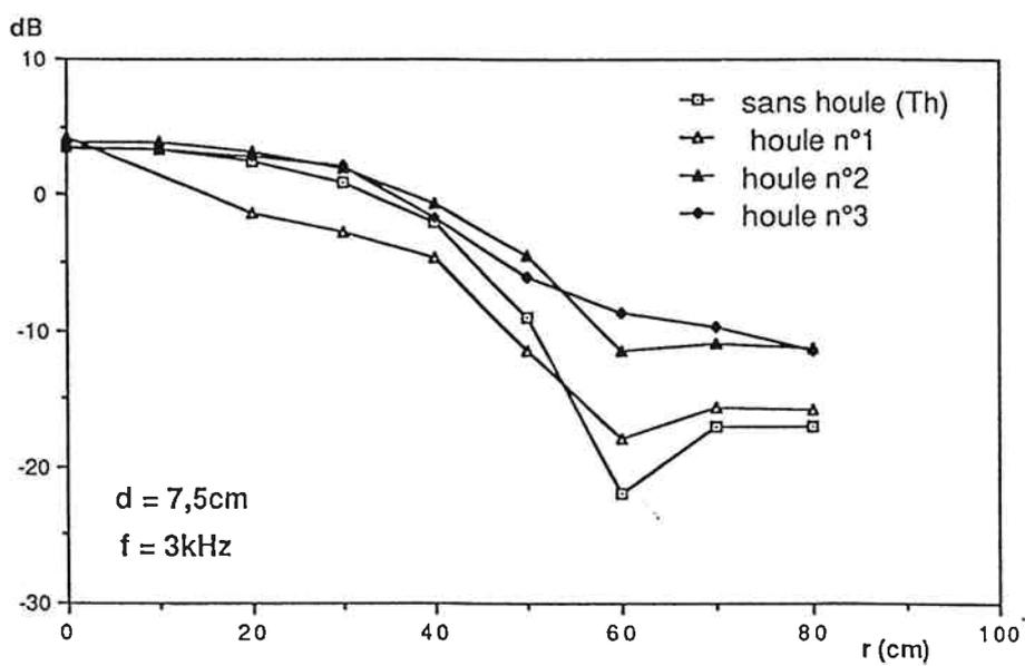
Figure 5 Atténuation du niveau de pression transmise
