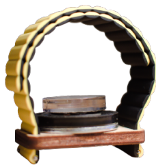
FIGURE 1 – Bracelet vibrotactile utilisé dans le projet Staccato
