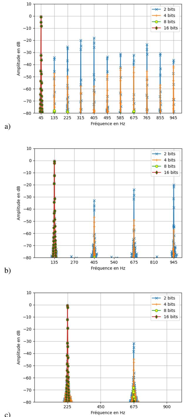
FIGURE 6 – Spectre des sinus de l'étude (de fréquence 45, 135 et 225 Hz respectivement en a), b) et c)), pour chaque niveau de quantification.
