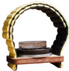
FIGURE 1 – Bracelet vibrotactile utilisé dans le projet Staccato
