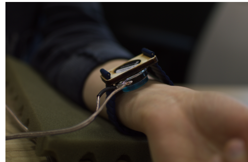
FIGURE 2 – Vibreur fixé sur le poignet d'une participante à l'aide du bracelet.
