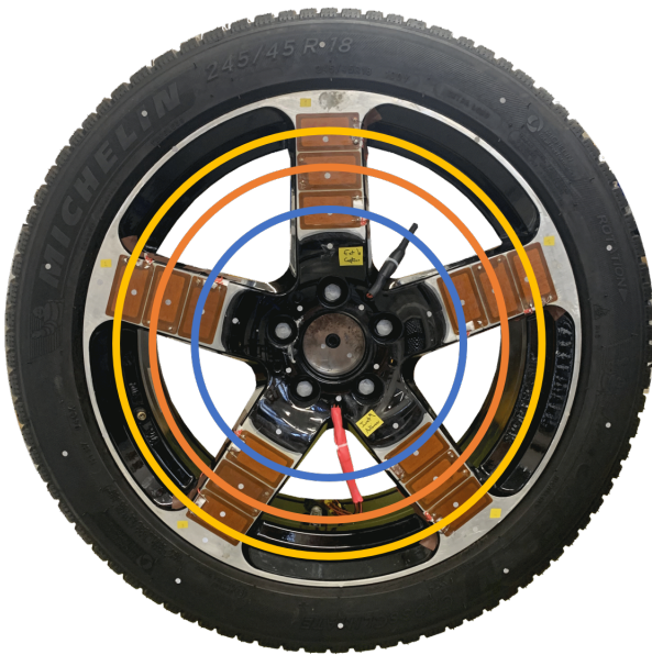
FIGURE 2 – Répartition des 15 transducteurs piézoélectriques en 3 couronnes.
