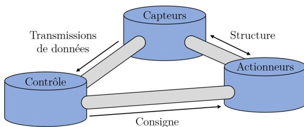
FIGURE 1 – Schéma de principe d'une smart-structure.
