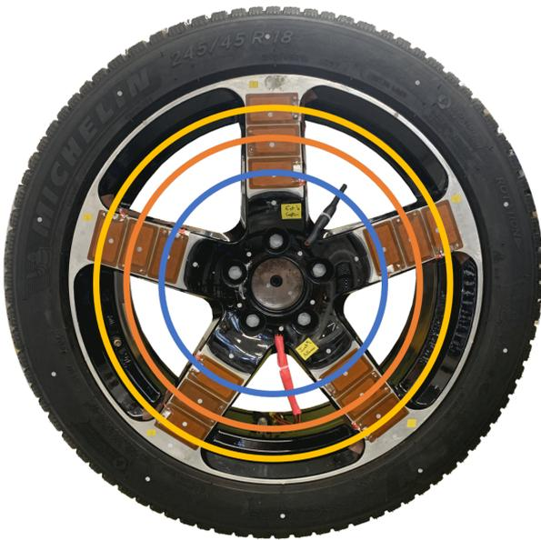
FIGURE 2 – Répartition des 15 transducteurs piézoélectriques en 3 couronnes.
