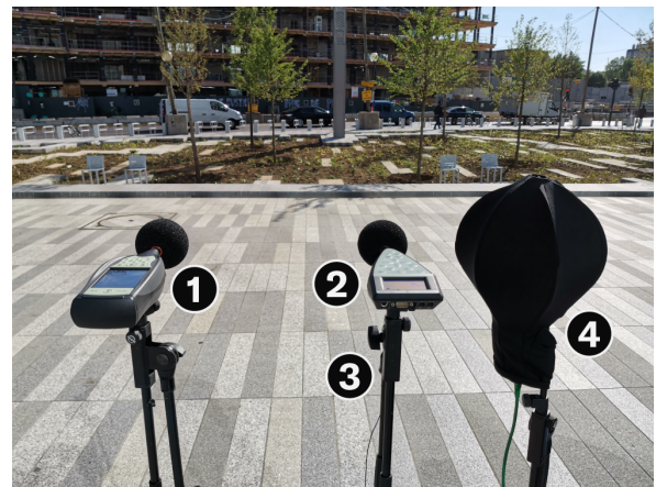
Figure 2 – Matériel utilisé lors des prises de son. 1) B&K 2250 (position mobile); 2) B&K 2238 (position de référence); 3) DPA 4060 (position de référence); 4) Mh Acoustics Eigenmike (position fixe). Image : Nicolas Misdariis.
