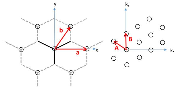
FIGURE 1 – Structure périodique du nid d'abeille (gauche), points de discrétisation du spectre en nombre d'onde (droite).
