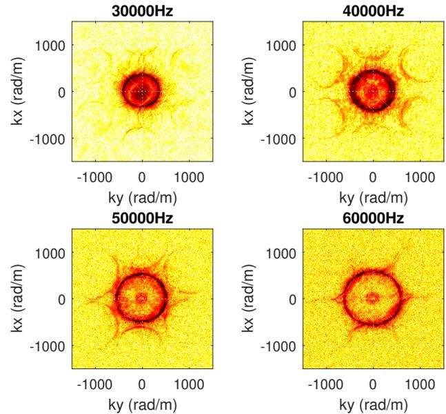
FIGURE 4 – Spectres en nombres d’ondes des champs vibratoires à différentes fréquences.
