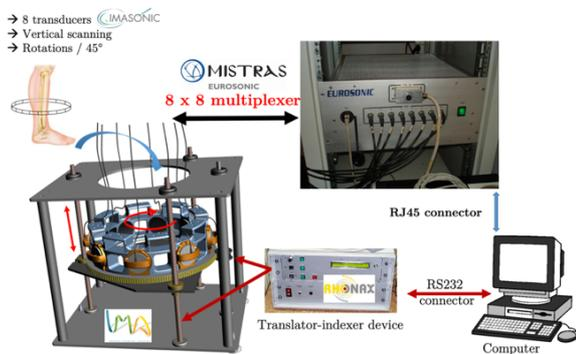
Figure 1 - Antenne circulaire avec 8 transducteurs
