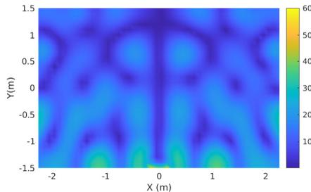
FIGURE 11 – Niveau de la pression diffractée avec contrôle aux points de visualisation à 254,1 Hz.
