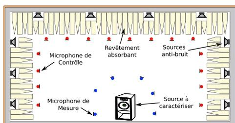
Figure 1 : schéma d'une salle semi-anéchoïque à technologie active
