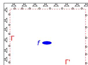
FIGURE 2 – Croquis d'une salle semi-anéchoïque à technologie active.
