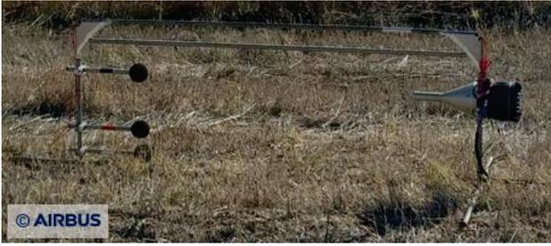
Figure 4 – Banc Airbus d'évaluation de l'impédance de sol
