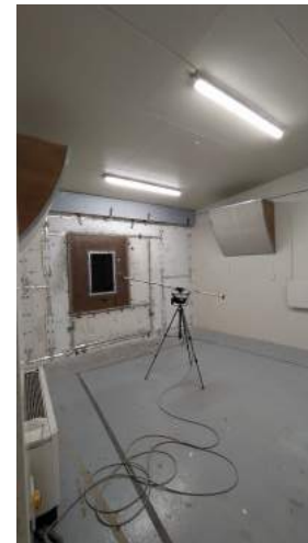
FIGURE 11 – Montage mis en place entre les deux salles réverbérantes
