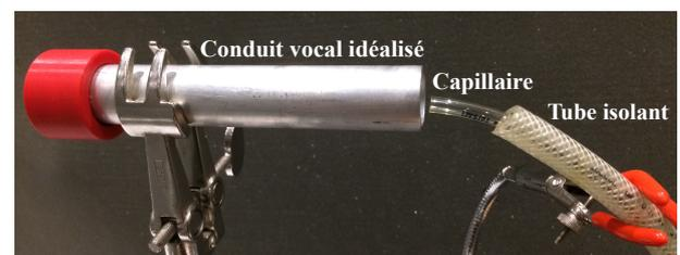
FIGURE 1 – Photo du capillaire d'excitation et du guide d'ondes.
