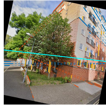
FIGURE 4 – Segments contribuant à l'estimation des PF avec la méthode LB (une couleur par PF). Les troncs d'arbres sont pris en compte dans l'estimation du zénith. Mais, n'étant pas parfaitement verticaux, ils corrompent l'estimation du zénith et donc de la ligne d'horizon.
