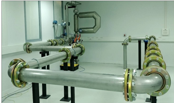
Partie principale : débitmètres de référence et tuyauterie
