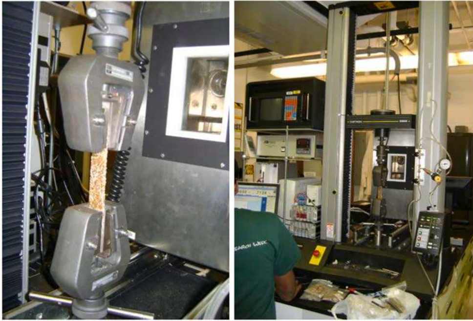
Fig. 5. Instron 5866 tensile test machine.
