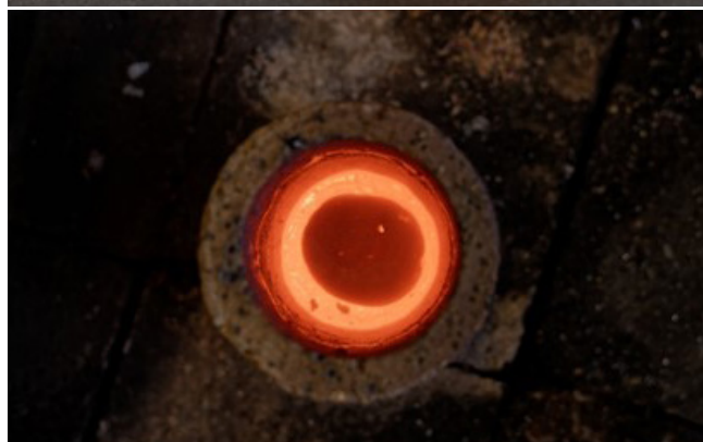
Fig. 12 : Fonte du cuivre dans le creuset « préformé ». Crédit N. Gilbert, V. Martin.
