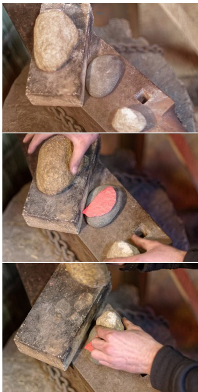
Fig. 7 : Séquences de mise en forme par martelage et recuits, au moyen des marteaux en pierre. Crédit N. Gilbert, V. Martin.
