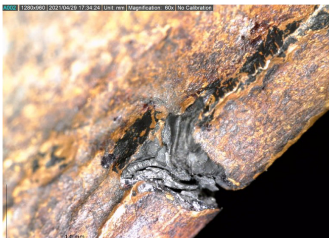
Fig. 8 : Fissure observée sur les bords de l'un des anneaux en cuivre fabriqué par martelage à froid. Grossissement x60 (caméra optique Dino-Lite). Crédit V. Martin.
