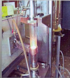
Elaboration des aciers par fusion d'éléments purs mis ensemble, par induction à haute fréquence sous atmosphère d'argon
