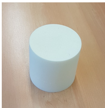
FIGURE 1 – Echantillon de mousse de polyisocyanurate industrielle (Recticel)
