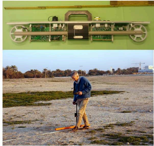
Fig. 4. Electronique et bobines du prototype CS60 et mode d'utilisation sur le terrain du CMD 'mini-explorer' à 3 réceptrices.
