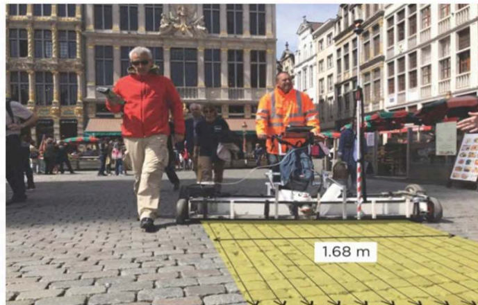
Fig. 3. Radar-sol (Ground Penetrating Radar) comprenant 15 couples d'antennes émettrice/réceptrice espacés de 12 cm assurant une fauchée de 1,68 m. La fréquence centrale est de 200 MHz. Photographie de l'appareil lors de son utilisation sur la 'Grand-Place' de Bruxelles.
