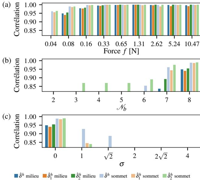
FIGURE 4 – Corrélation entre les déplacements théoriques et estimés en fonction de la force (a), du nombre de bits de quantification pour  $f = 0.08$  N (b) et de l'écart-type du bruit pour  $f = 0.08$  N (c).
