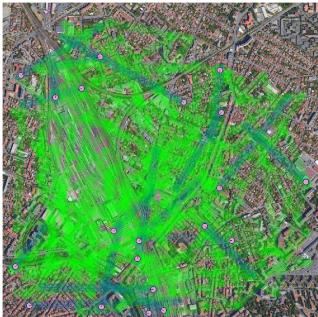
FIGURE 3 – Un exemple de scénario sur une zone urbaine de 2 km x 2 km. 20 UAV sont représentés par des cercles (avec leur vecteur de vitesse). Les contrats 4D (et leurs tubes) sont représentés en vert. Les segments actuels sont représentés en bleu.
