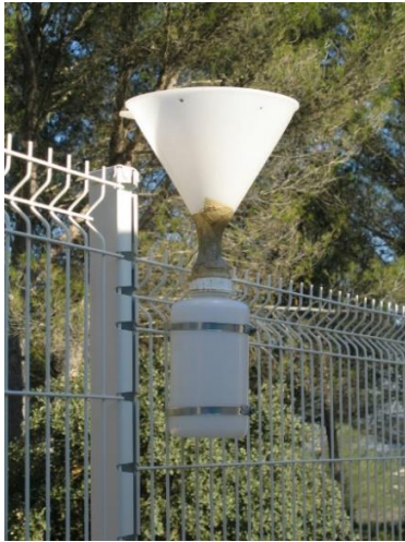
Figure 6 : Station de mesure et sites de prélèvement des retombées atmosphériques. Campagne TRAFIC 2021.
