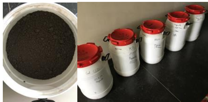
Figure 27 : Photos prises au GISFI montrant les mélanges de sols contaminés avec les réactifs
