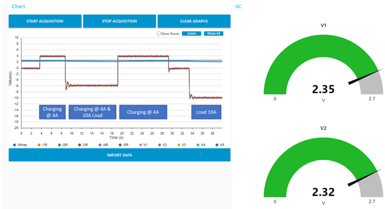
Figura 6: Sistema de supervisión del módulo de supercondensadores implementado en NODE-RED en el que se visualiza un gráfico con la tensión y corriente de cada uno de los módulos durante diferentes fases de carga y descarga (izquierda) y la tensión instantánea en el módulo uno y dos (derecha).
