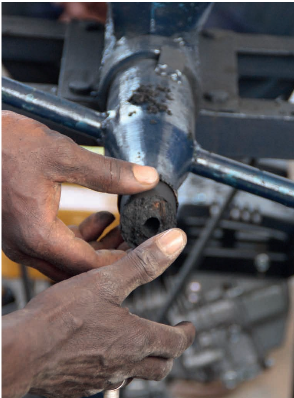
Photo 2 : Récupération des briquettes de biocharbon dans l'unité artisanale de Keur Madicke, © Jessica Rat / Gret
