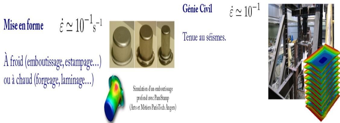
Figure 3.3 Exemple déformation plastique (mise en forme des matériaux et application en Génie civil ),[32].
