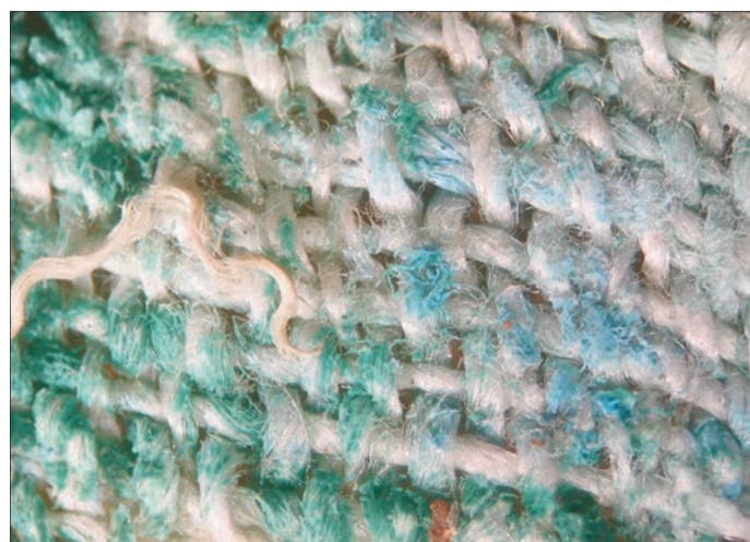
Fig. 19 – Reims, tramway : exemple de dépôt d'oxydes de cuivre à la surface du tissu (cliché sous loupe binoculaire : F. Médard).
