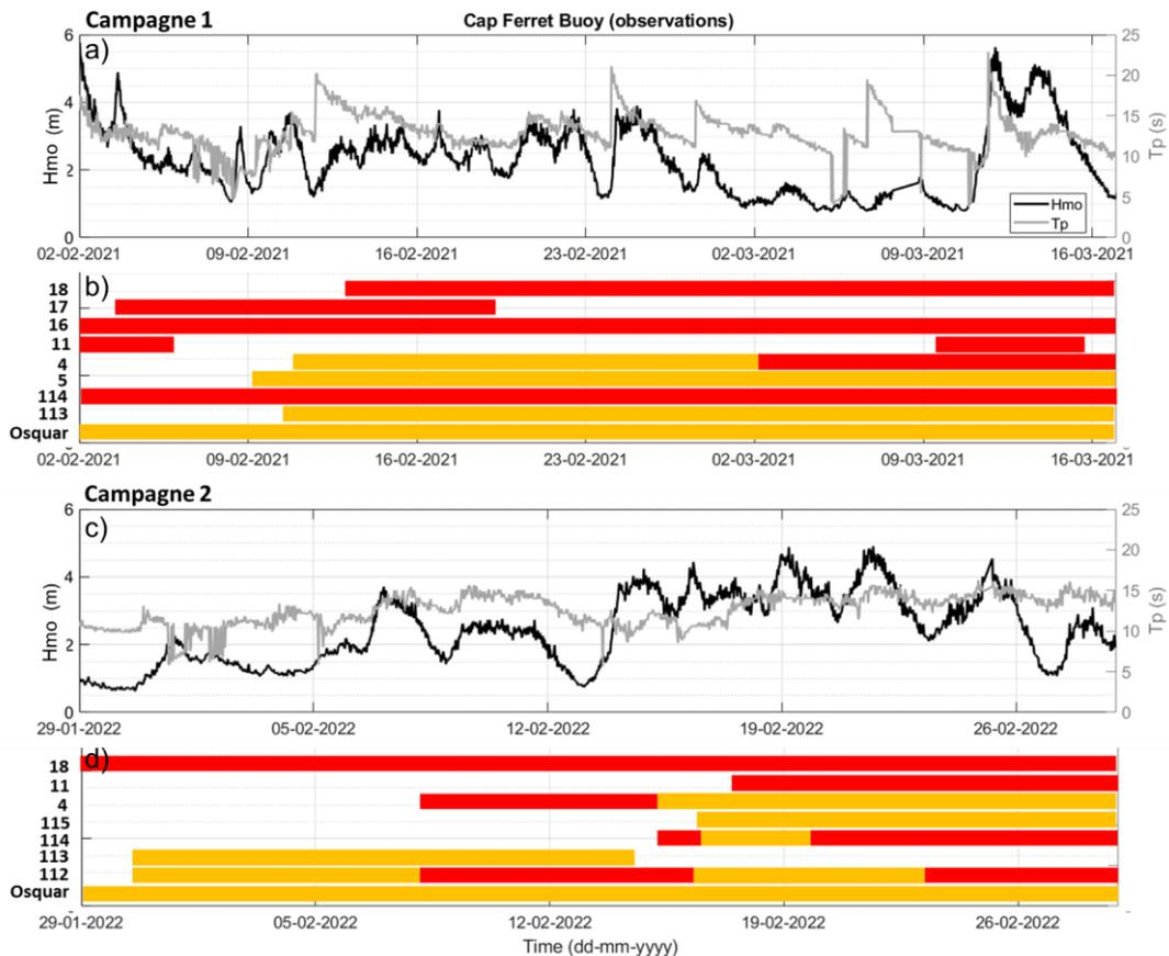
Figure 2. Séries temporelles de  $Hm0$  et  $Tp$  au large (bouée Cap Ferret) lors des campagnes de mesures a) et c), périodes d'acquisition de données et type de mesures b) et d) : courant et pression (jaune), pression (rouge).
