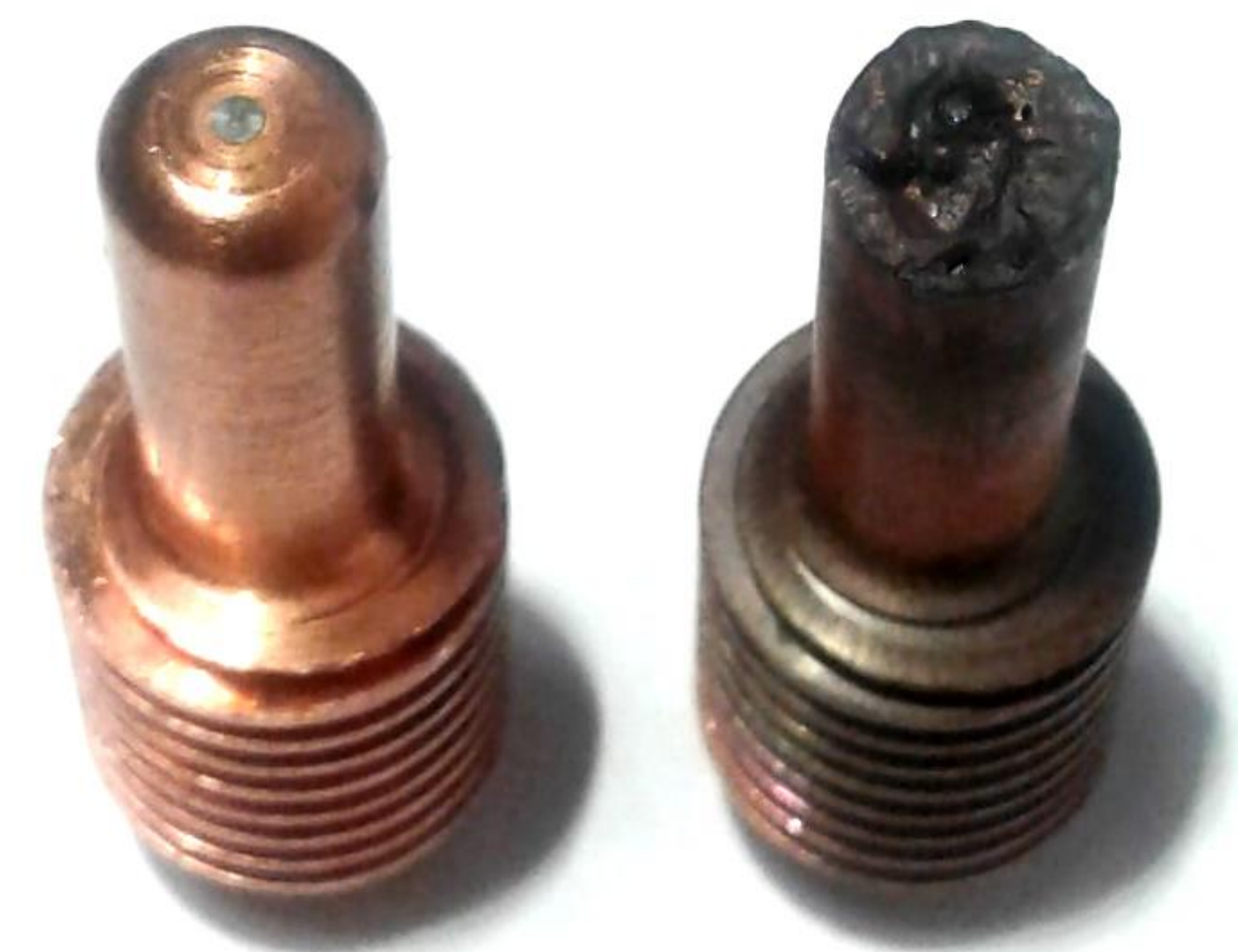
Figure 2: Electrode neuve/détruite. On distingue l'insert en Hf en haut de la pièce neuve.
